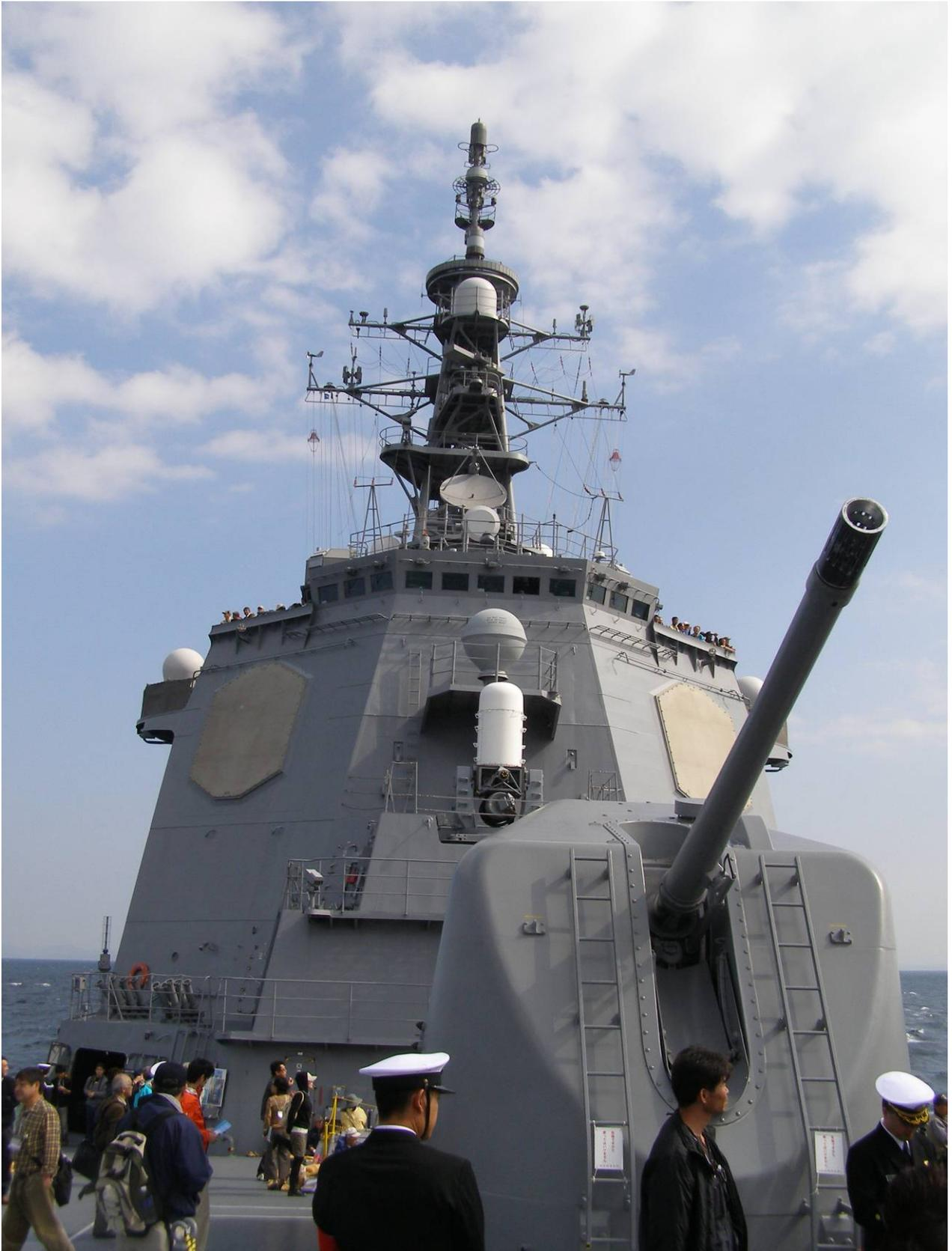
これが最もイージス艦っぽいアングル。前方にあるのはオート・メラーラ製127mm単装砲で、この管制用に射撃指揮装置FCS-2-21を艦橋上部に装備しています。艦橋に貼り付けられた六角形のものはフェーズド・アレイ・レーダー、360度死角無しという優れものだ。最大探知距離は500kmに及び、200以上の目標を追尾できる。また、レーダーのエネルギーを集中させてスキャンすると、なんと1000km以上の最大探知距離を実現できるのだそう。いやあ、凄すぎるなあ。ミサイル防衛作戦時に使用されるよ。これ以外にも3連装短魚雷発射管を装備している筈だが撮り落としたのかも知れない。
